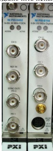
Рисунок 6. Передние панели модулей NI PXI-5402 и NI PXI-5114
