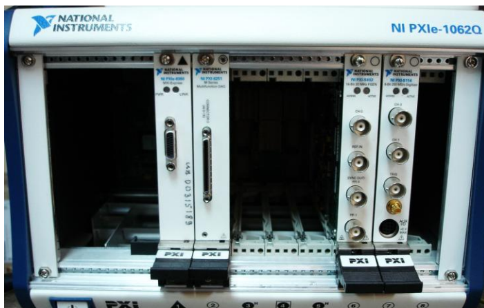
Рисунок 5. Кейт с модулями PXI, используемыми в работе
